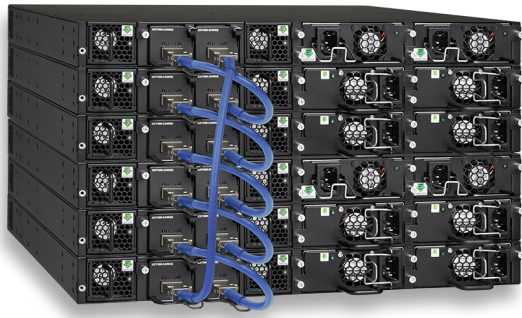
Figure 1 : Jusqu'à 12 switches Ruckus ICX 7450 peuvent être empilés ensemble, en utilisant deux ports QSFP+ de 40 Gbit/s full duplex pour une connexion intra-pile entièrement redondante avec 960 Gbit/s de bande passante d'empilage.
