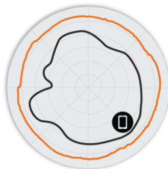
Figure 3. Diagrammes d'antennes Azimut T750 5 GHz
