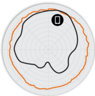
Figure 2. Diagrammes d'antennes Azimut T750 2,4 GHz
