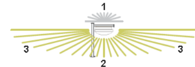
FIGURE 2 Couverture de point d'accès omnidirectionnelle type, vue latérale - Option 1
