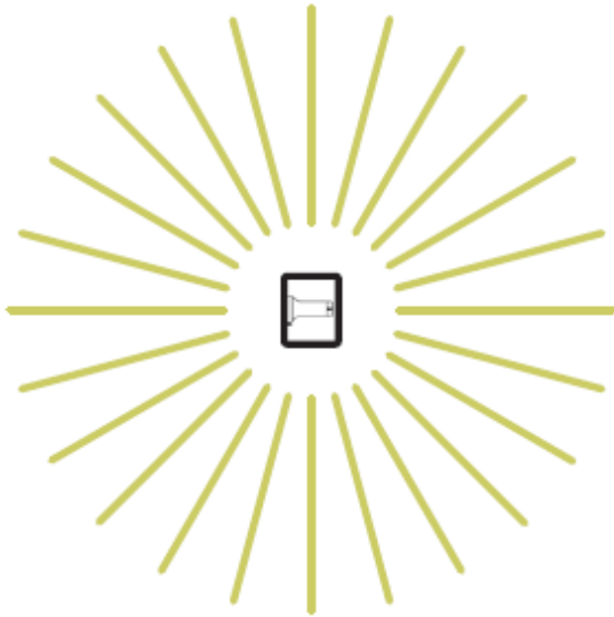
FIGURE 5 Couverture de point d'accès omnidirectionnelle type, vue de haut - Niveau de couverture de l'azimuth
