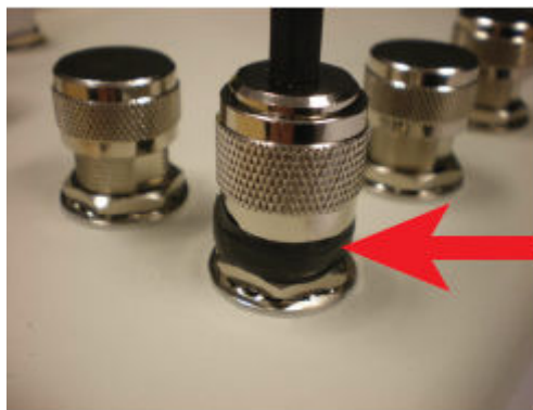
FIGURE 13 Envelopper les fils de connexion exposé
