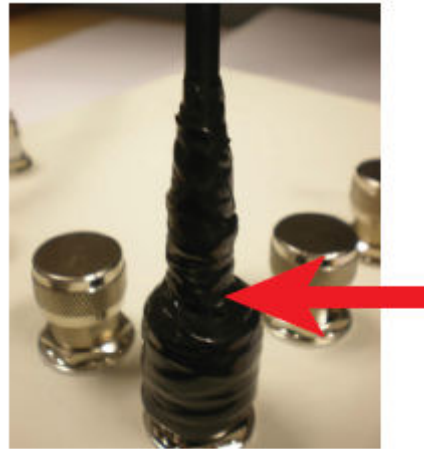
FIGURE 19 Enrouler le ruban isolant
