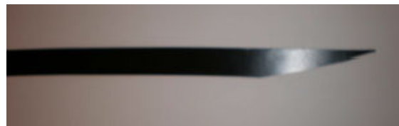
FIGURE 14 Couper l'extrémité du ruban isolant
