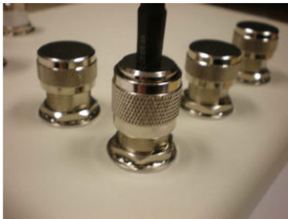
FIGURE 12 Connecter le câble au connecteur
