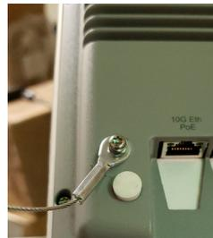
4. Fixez le point d'accès au support de montage de la barre en T et glissez l'excédent de câble de sécurité entre le point d'accès et la dalle du plafond pour le dissimuler.
